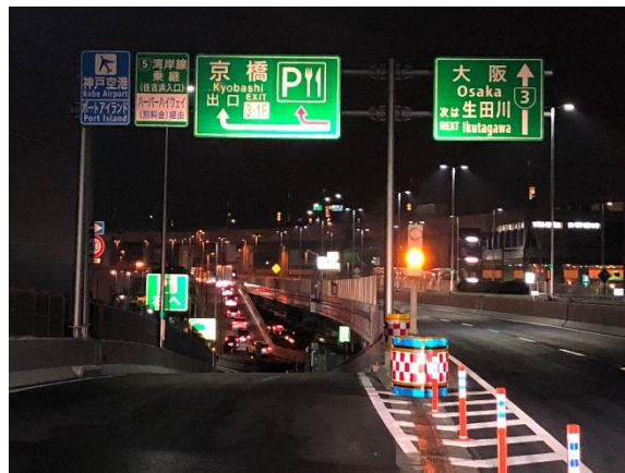
超高輝度反射材料を用いた標識(例)
