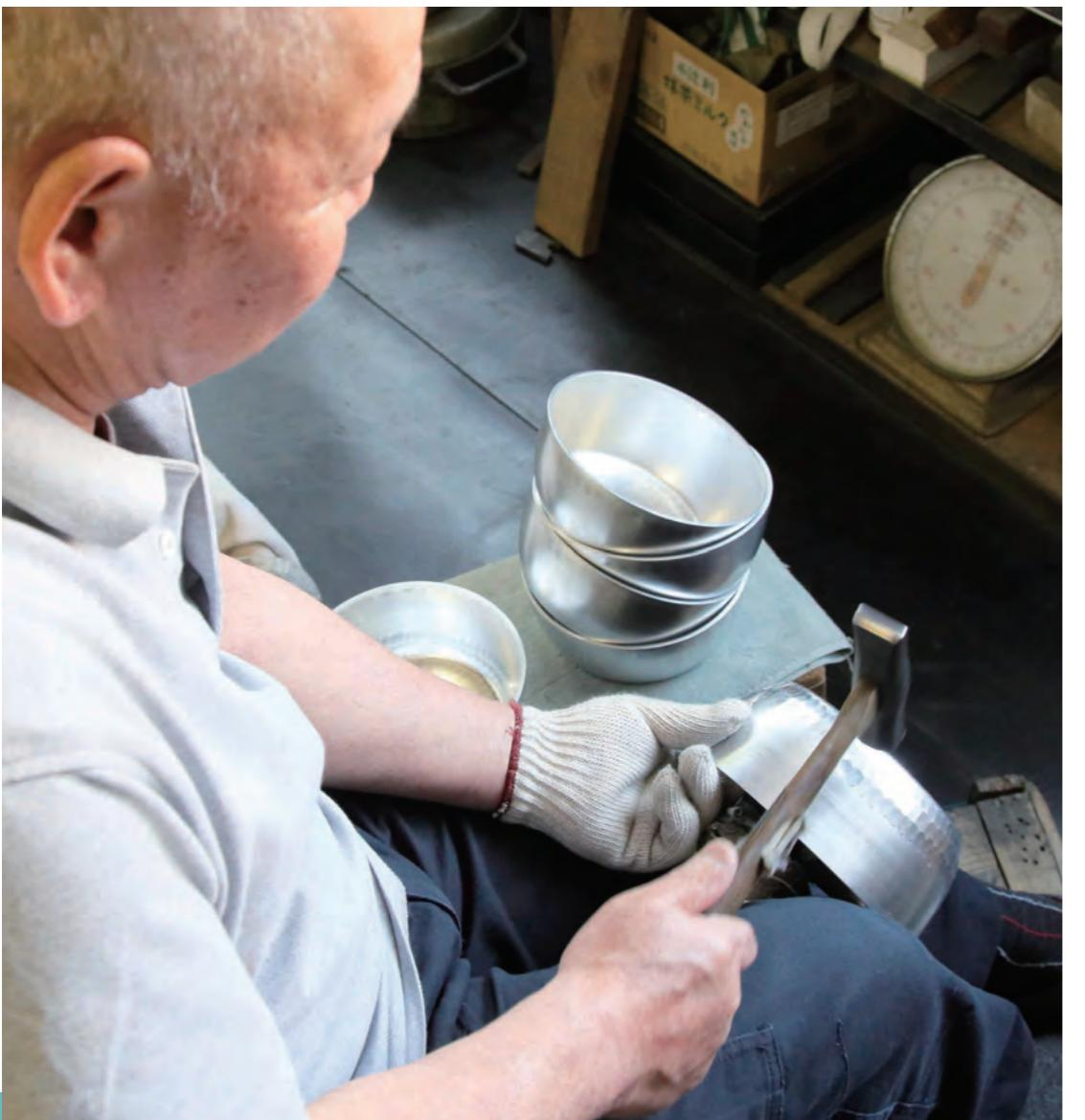
ひとつの鍋で400～500回叩いて仕上げる。叩いた瞬間に金属の微粒子が光に反射して見え、強い力で締まっていくのがわかる。「1日に2～3万回。多いときで4万回叩く計算になるので、集中していてもこれだけの回数なので打ち損じは避けられません。毎日95点以上の出来かな。今日こそ100点をとるぞという意気込みでやっているので飽きることがないんです」。姫野さんが製作しているのは一番人気の雪平鍋。ちなみに段付鍋は段がついていることで吹きこぼれを防ぎ、せいろのせれば蒸し器にもなる日本独特の鍋。「これと雪平鍋があれば和食の8割以上、調理できます。家庭ならこの2種類で十分だと思います」
