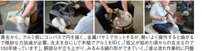
写真左から。アルミ板にコンパスで円を描く。金属バサミでカットするが、勢いよく操作すると曲がるので微妙な力加減が必要。丸太を台にして木槌でアルミを叩く。「祖父が始めた頃からの丸太なので約100年使っています」。胴部分が立ち上がり、みると丸い鍋の形ができる。「昔は流れ作業的に円盤に切る、底・胴を叩く、柄をつける職人がいました。今は僕が全部やります」
