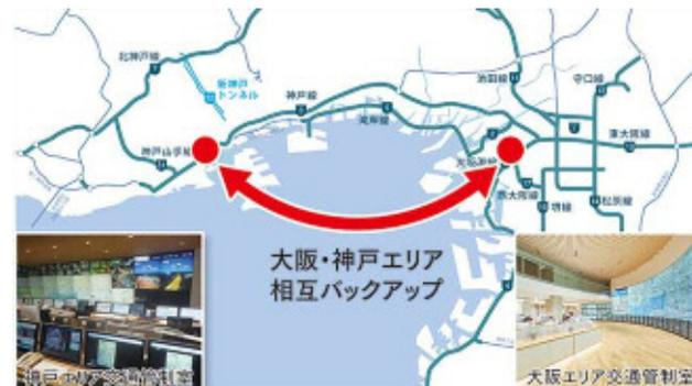
大規模災害（設備障害含む）で、大阪・神戸いずれかの管制室が被災した場合、**被災していない管制室で、全エリアの交通管制を実施可能**
