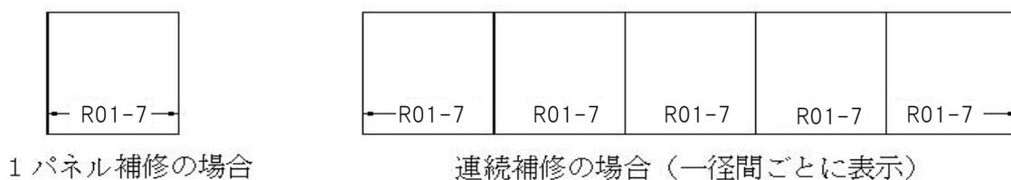
図-2.4.2 施工年月（和暦）・施工範囲の明示箇所
