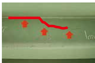
溶接部から発生したひび割れ状況
