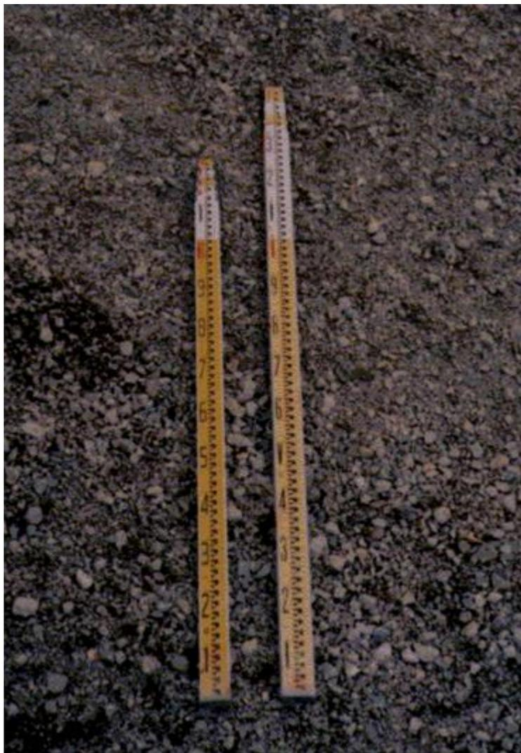
（注）箱尺は、カメラアングルによっては視差が生じる。目盛り、数字がかくれぬように適当な細巾または薄板の当て尺を使用する必要がある。
