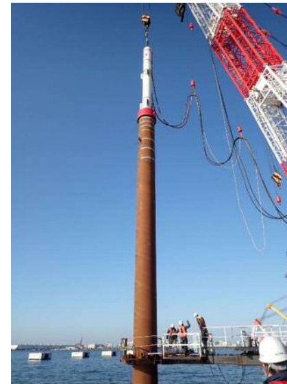
図-3. 先行して実施した衝撃載荷試験の状況
