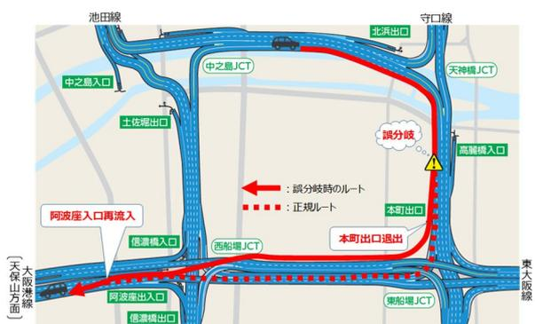
図-2 連続分岐での誤分岐のイメージ(本町出口)
