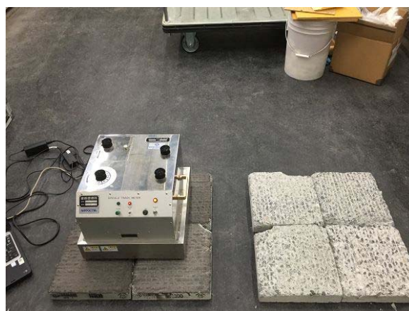
写真-3 きめ深さの測定状況（CTメーター）
