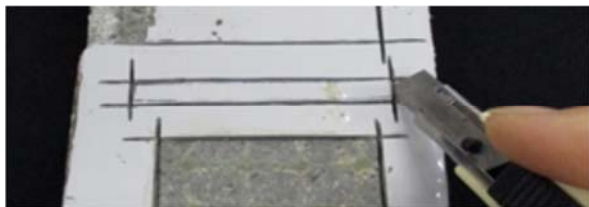
図-2 試験状況 (カッターナイフ剥離試験)
