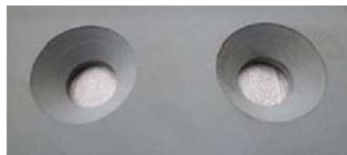
図-14 皿加工後の連結板
