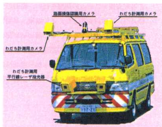
図-2 路面点検車の外観
