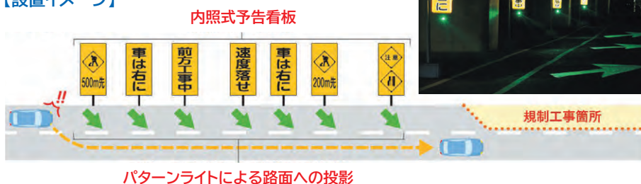
投影技術を活用した工事規制時の車線誘導
